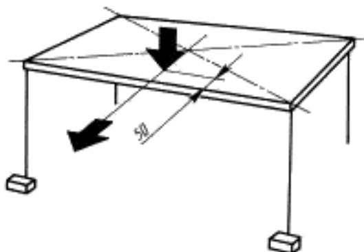
Увеличивают горизонтальную силу до тех пор, пока хотя бы одна из ножек с противоположной стороны стола не оторвется от пола.
